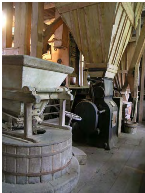
Mlecí podlaha v Tenorově mlýně s obyčejným kamenným složením a válcovou mlecí stolicí s rezervátem, za ní je loupačka na zrna. Foto J. Pokorný 2008
